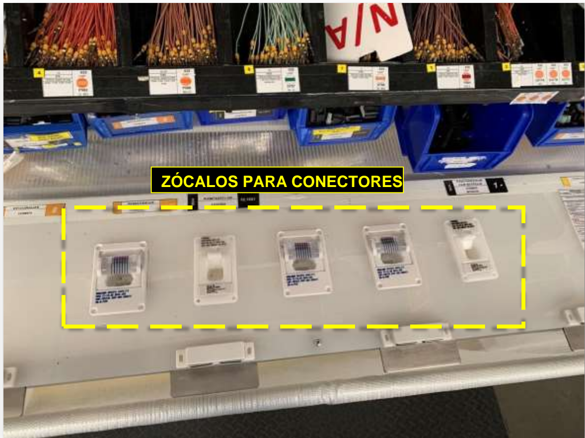
Ilustración 30 Pokayoke en mesa de subensamble 2
